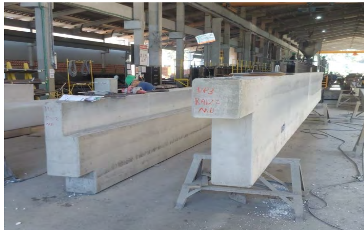
Fabricação das peças pré-moldadas dos galpões 1 e 2.
